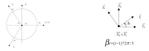
On donne (ci-dessus) le paramétrage des 3 repères lies au mors 1,2 et 3. On supposera que les actions mécaniques des 3 mors sur le piston 4 sont identiques.
