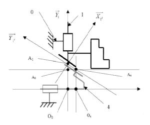
Cette partie va consister à déterminer les efforts qui s'exercent sur la pièce 5 dans l'étude afin de vérifier la donnée fournie par le fabricant du mandrin qui donne une action de serrage de 2000N sous une pression de fonctionnement de 6 bars.
